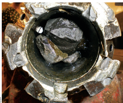
Vulkaniskt material i form av basalt har fångats i ett rör på ett forskningsfartyg.
