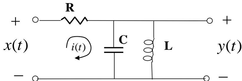
$$H(\omega) = \frac{j\omega / RC}{(j\omega)^2 + j(\omega / RC) + (1 / LC)}$$
